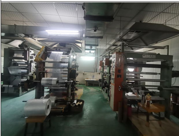
图 5 印刷车间（密闭车间，采用集气罩对废气进行收集）
